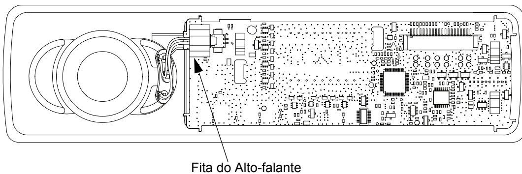
Figura 5-36 Montagem da Fita do Alto-falante na PCB
